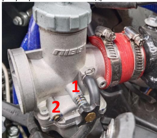
1- Регулировочный винт Холостого хода 2- Винт качества смеси
